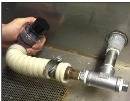
写真1. 気密曲げ試験状況(接着部)
