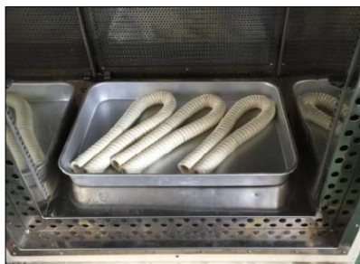
写真6. 恒温槽内部状況 (ホース部)
