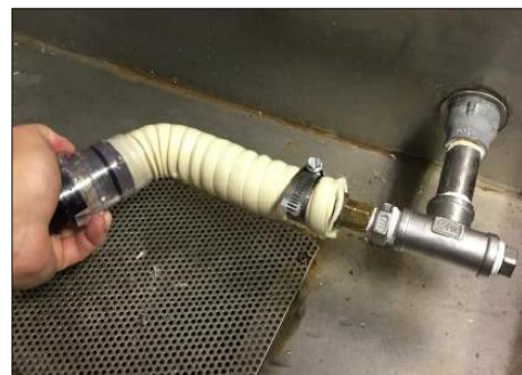
写真2. 気密曲げ試験状況(ホース部)
